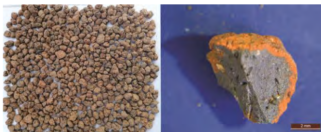
Figura 1. Grupo de ACL comercial nacional (izquierda) y detalle de la capa anaranjada y el coraz n negro (derecha).
